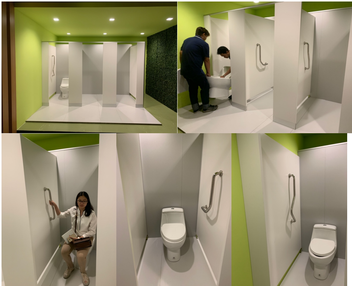
Mockup room การทดสอบการใช้งานของราวจับทั้งสามแบบ
